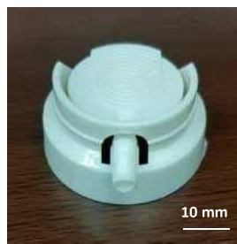
図1 試料(プラスチック製スプレーノズル)
