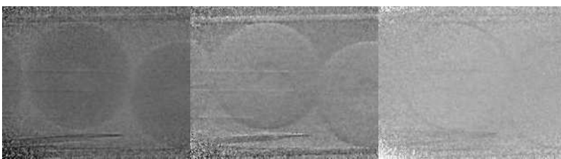
図2: X線回折格子干渉計（縞走査法）により1.5 msで得られた三枚の画像（左から吸収像、微分位相像、ビジビリティコントラスト像）。
