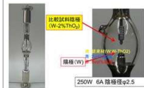
写真1 寿命試験を行った250W 超高压水銀灯
