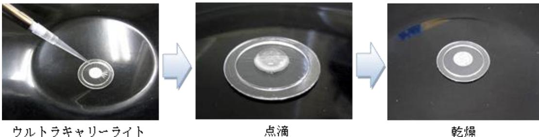
図1 ウルトラキャリアイトを用いた試料作成法
