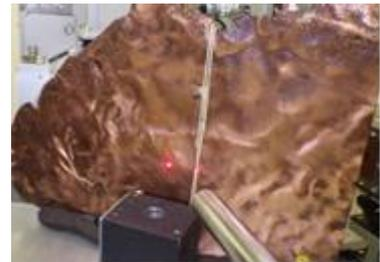
図1. 開陽丸の船底に使われたと思われる大きな銅板の分析。赤いスポットに左側からX線が照射され、円筒の検出器で蛍光X線がカウントされる。
