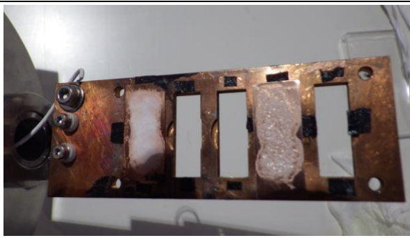
図1. 試料の固定。固体標準試料(左)、ポリエチレン袋に入れた底泥 (右)
