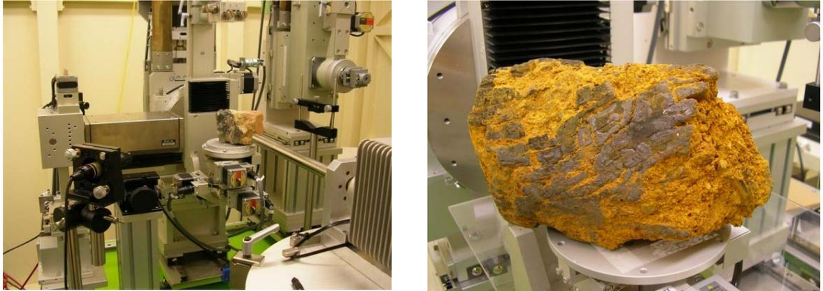
図1. 反射炉から出土したレンガの表面に付着したノロ（左）と出土した鉄滓（右）の BL07 における蛍光X線分析測定（赤いレーザービームがあたっているところがX線照射箇所）。
