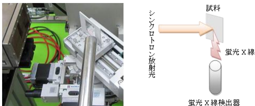
図2 シンクロトロン放射光による蛍光 X 線分析の様子
