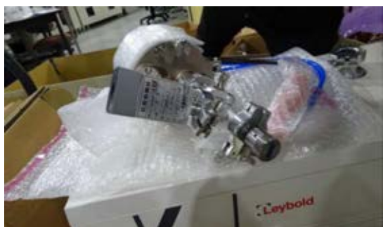
図4 X線反射率測定用試料容器
