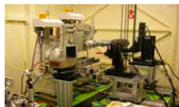
図5 回折強調イメージング (DEI) 装置
