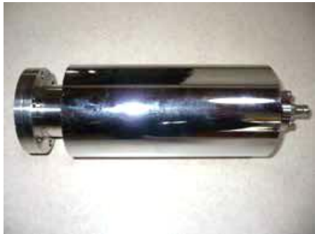
図 2: NICT が開発してきた電池駆動可能な小型の超高真空イオンポンプ。市販単 3 乾電池 16 本で 30 時間以上の動作が可能。
