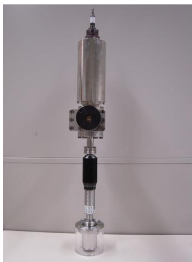
図 3: NICT と九州シンクロトロン光研究センターが共同開発した小型イオンポンプ付きの可搬型超高真空試料搬送導入装置
