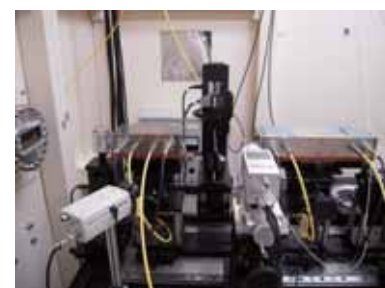
図 BL11 第 1 実験ハッチの様子 (上) と設置された XAFS 測定システム (下)。
