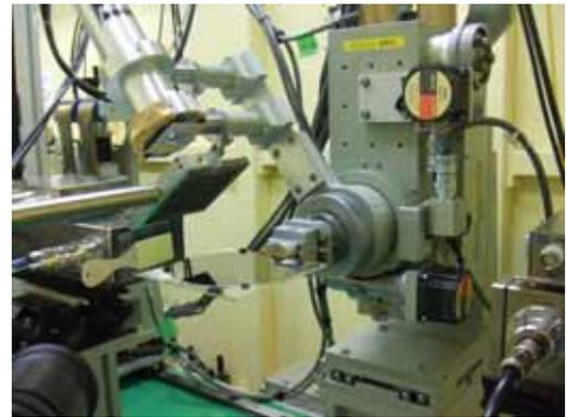
水平回転軸精密ゴニオメータにフーバー製ゴニオメータヘッドに装着した場合 BL15, SAGA-LS
