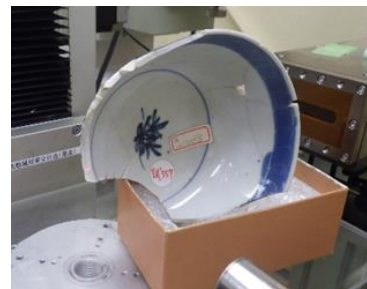
図1. 広瀬向2号窯から出土した碗のシンクロトロン蛍光X線分析測定。分光されたX線がレーザー光で光っている箇所を照射され、蛍光X線が手前の検出器に達し、蛍光X線スペクトルが得られる。
