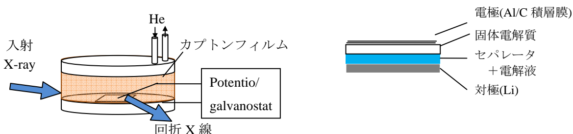
図1 in-situ GIXD 用セルおよび試料の構成
