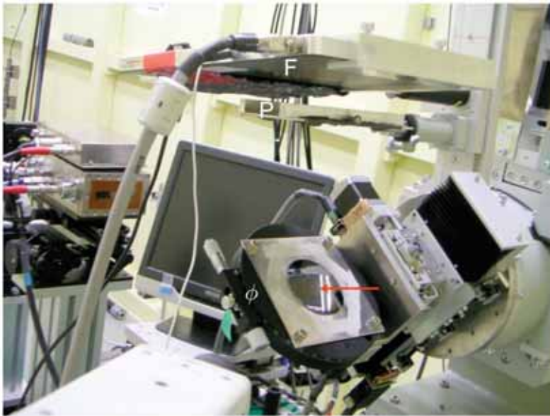
図1 実験配置。赤矢印は試料に入射するX線の方向を示す。アルミニウム製の試料ホルダーは面内回転ステージ( \phi )上に設置されている。
