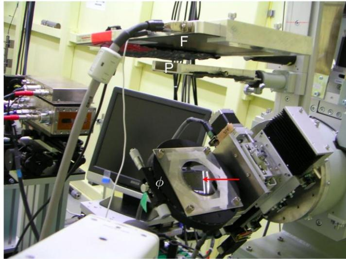
図 1 実験配置。赤矢印は試料に入射する X 線の方向を示す。アルミニウム製の試料ホルダーは面内回転ステージ ( $\phi$ ) 上に設置されている。F: フラットパネルセンサー
