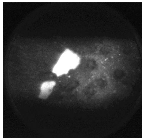
図2 280 eVの入射X線エネルギーで測定したHNBRの薄膜切片試料のX-PEEM像（100 \mu\text{m} FOV）
