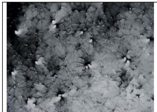
シンクロトロン放射光の使用により、X 線管球を用いた弊社所有の装置では従来観察が難しかった貫通螺旋転位が、明瞭に観察可能なことが実証できた。
