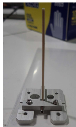
図-1 試験に用いたカラムおよびBL07への設置治具へのセット状況
