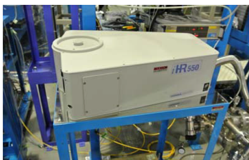
図3. 半導体材料深紫外域光学特性評価システムのイメージングスペクトロメータ
