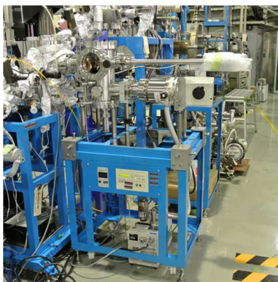
図2. 半導体材料深紫外域光学特性評価システムの試料ロードロック交換真空槽
