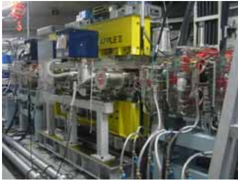
図3 長直線部LS3におけるAPPLE-II設置状況
