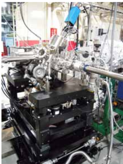
図5 BL10に設置した光電子顕微鏡(PEEM)装置の写真
