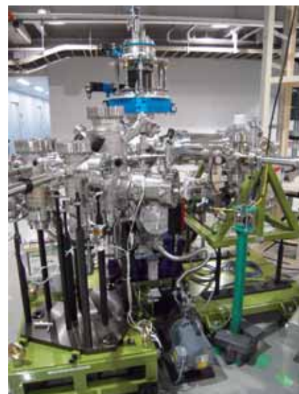
図5 BL10に設置した角度分解光電子分光(ARPES)装置の写真
