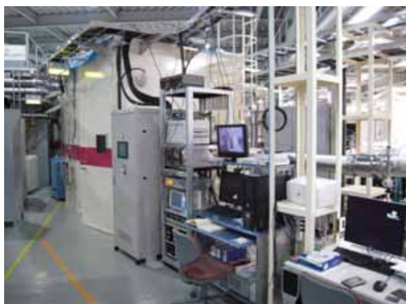
図7 BL11第1実験ハッチと設置したXAFSスペクトル計測システム
