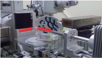
図1. BL07での試料位置。左側からX線が出て、試料にあたる。試料表面から放出された蛍光X線が右側の細長い管に導入されSSD検出器で測定される。
