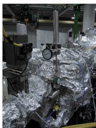
微量酸素導入機構は、光学素子真空槽に取り付けたヴァリアブルリーク/VLブと、酸素を封入した(〜0.5MPa)シリンダー、ガス補充用の分岐経路、等で構成される。
