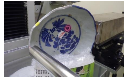
図 1. 白石焼の皿のシンクロtron蛍光 X 線分析測定。X 線がレーザー光で光っている箇所に照射され、蛍光 X 線が検出器に達し、蛍光 X 線スペクトルが得られる。
