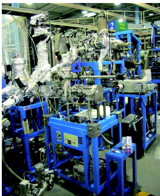
図3 半導体材料深紫外域光学特性評価システム
