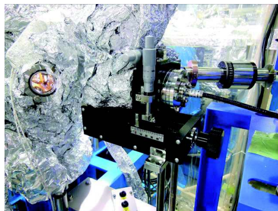
図4 半導体材料深紫外域光学特性評価システムのバンドルファイバ導入部
